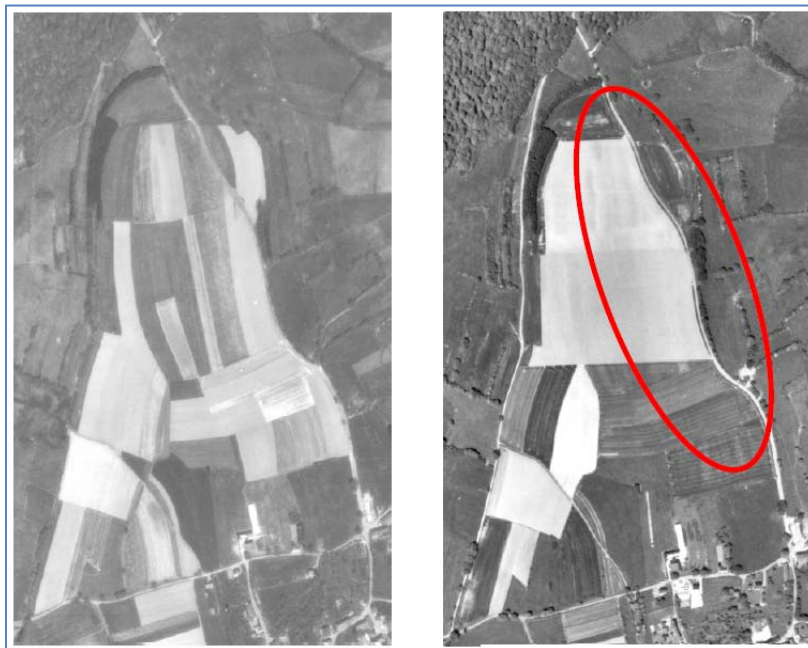
Figure 1: Impact de l'évolution du parcellaire agricole sur la longueur de pente (à gauche, parcellaire en 1984; à droite, parcellaire en 1992) [Source: S.Dautrebande, 2003]
