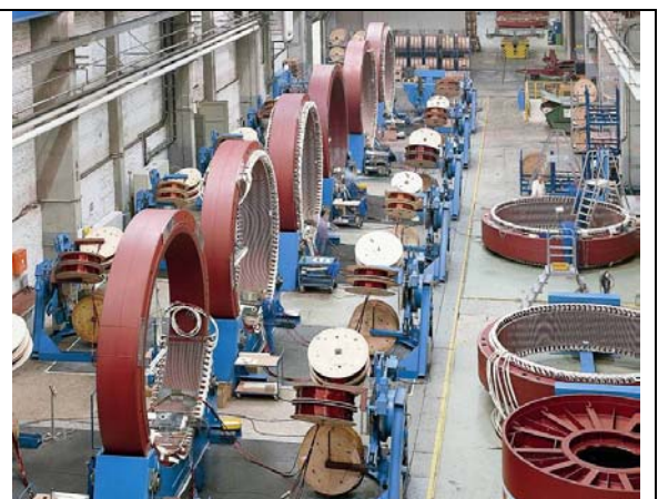
Atelier de fabrication de génératrices multipolaires pour éoliennes - Enercon
